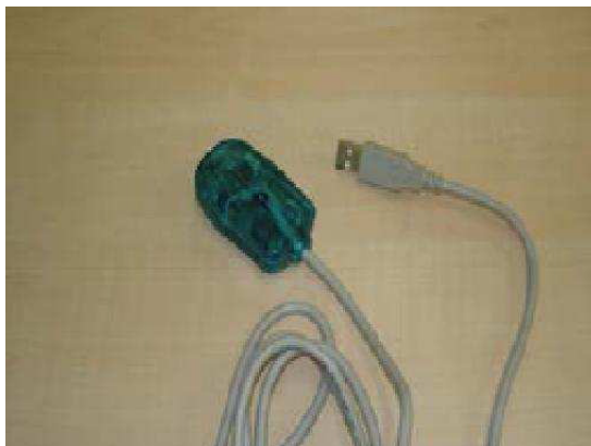
Figura 66: foto da interface que transfere dados do pingüim para computador.
