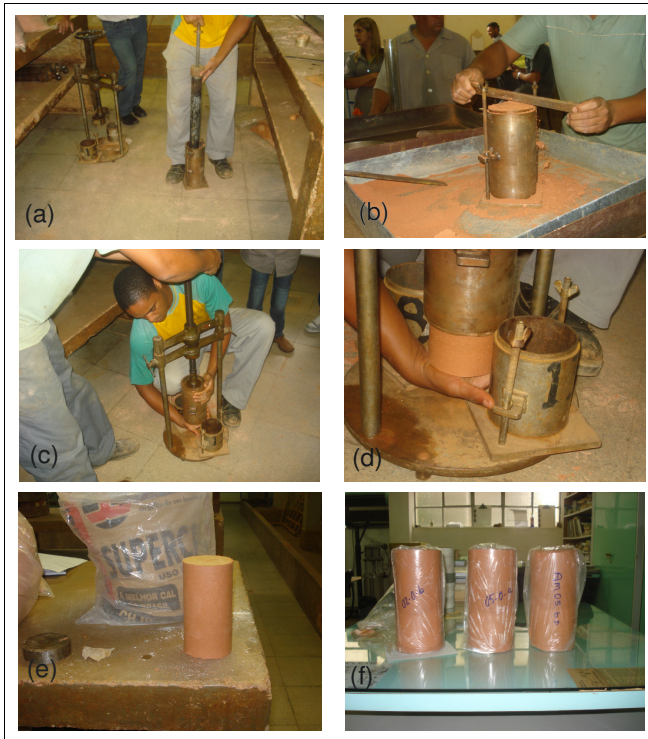
Figura 4.9 - Etapas da moldagem dos corpos de prova.
