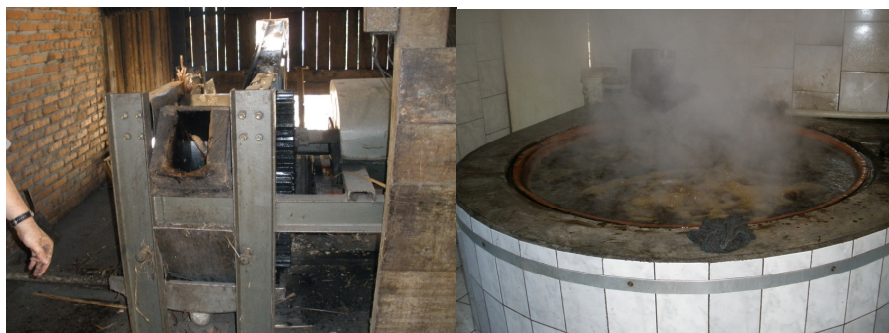
Figura 2. Moenda e tacho utilizados para a produção de melado em Benedito Novo, Santa Catarina. (Acervo do autor)
