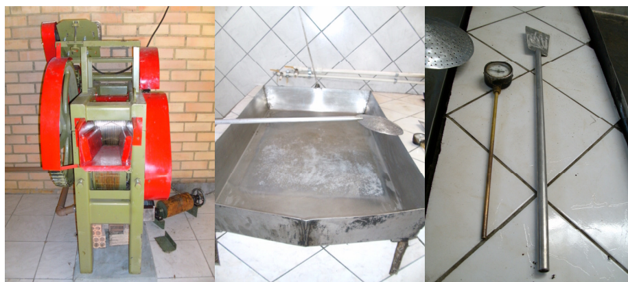
Figura 3. Moenda, tacho, termômetro e espátula para a produção de melado em Santa Rosa de Lima, Santa Catarina. (Acervo do autor)
