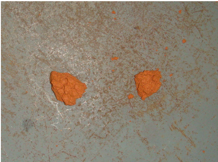
FIGURA A1.9 – Grumo de solo fragmentado em duas partes após a queda livre. Indicativo que o solo se encontra com umidade próxima à umidade ótima.
