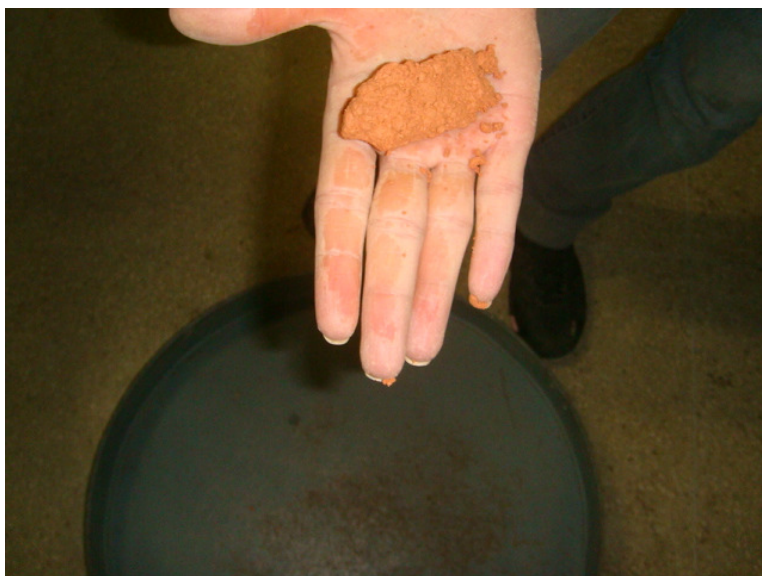
FIGURA A1.8 – Formato do grumo de solo apertado pela mão. Na condição de umidade próxima a umidade ótima, a palma da mão fica levemente úmida.
