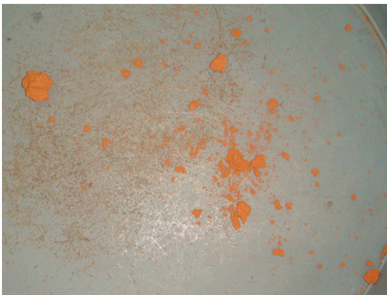
FIGURA A1.5 – Solo muito fragmentado após a queda livre
