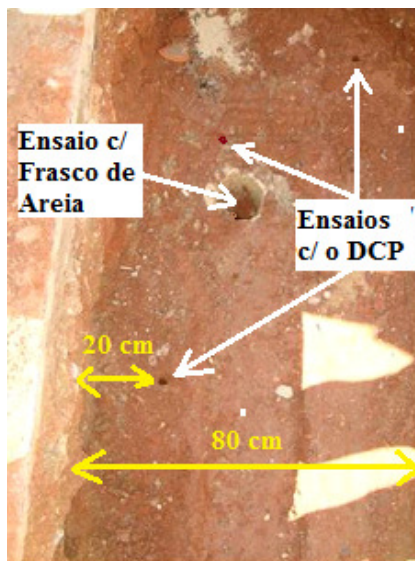
FIGURA 4.36 – Localização dos ensaios realizados com o Frasco de Areia e DCP (BE, EX e BD) - Vala 2.
