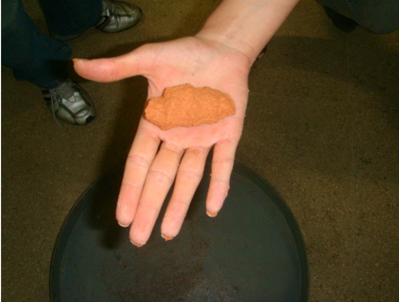
FIGURA A1.6 – Formato do grumo de solo apertado pela mão
