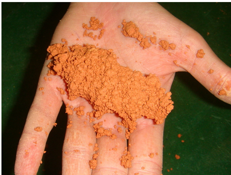
FIGURA A1.3 – Formato do grumo de solo após aperto da mão
