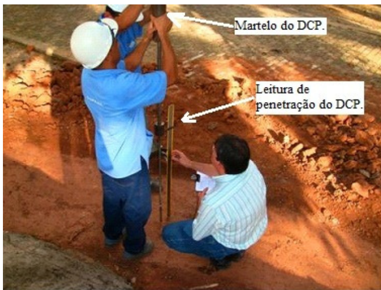
FIGURA 5.6 – Ensaio com o DCP realizado na quarta camada - Vala Experimental 1.
