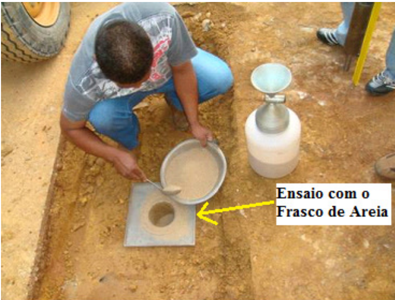
FIGURA 4.45 – Ensaio do Frasco de Areia – Vala 3.
