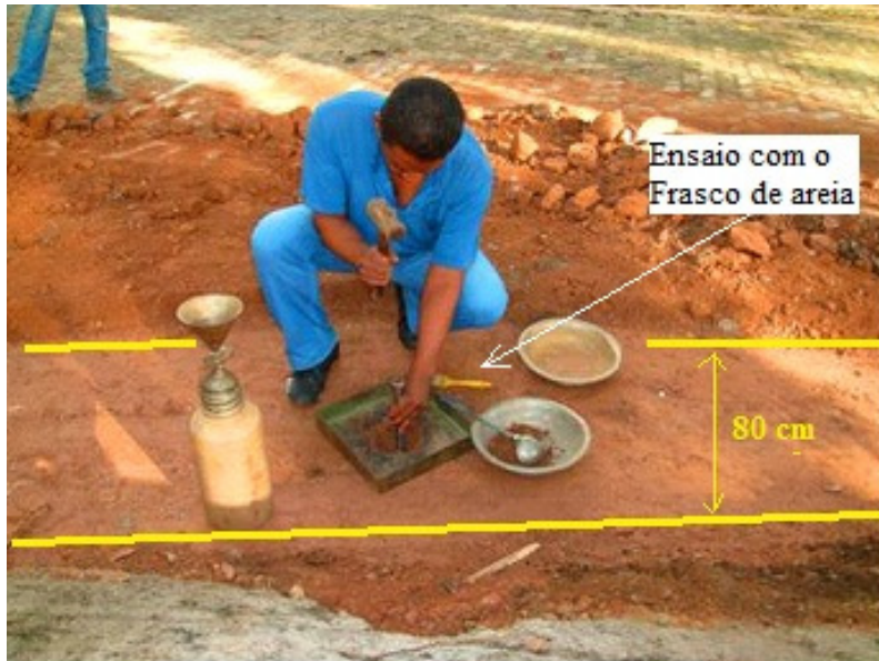
FIGURA 5.7 – Ensaio com o frasco de areia da quarta camada - Vala Experimental 1.
