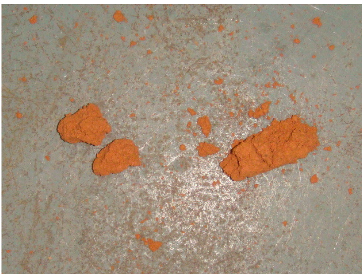
FIGURA A1.10 – Grumo pouco fragmentado após a queda livre. Indicativo que o solo se encontra com umidade próxima à umidade ótima.
