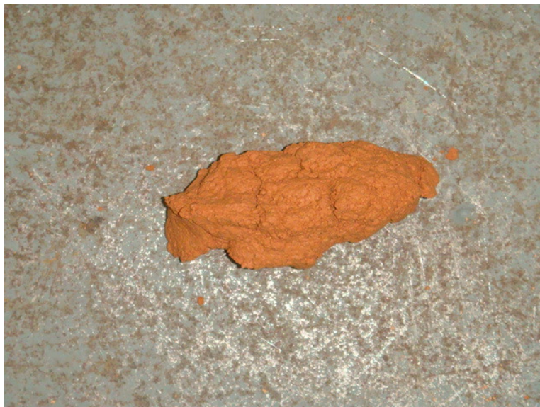
FIGURA A1.7 – Grumo de solo sem fragmentação após a queda livre
