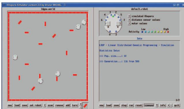
Figura 5.1: Interface principal do simulador do Khepera.
