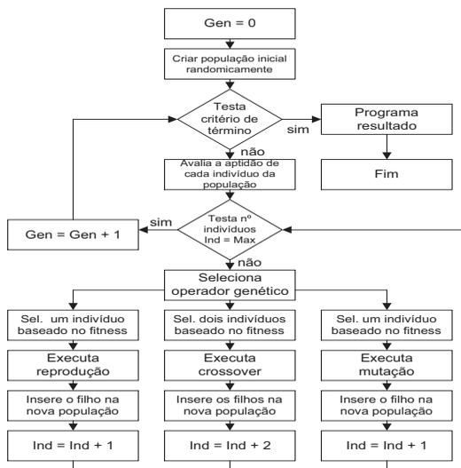
Figura 2.3: Diagrama de blocos do algoritmo da PG. Adaptado de (Martin, 2003).
