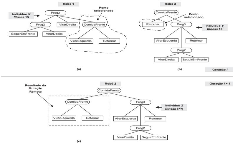
Figura 4.2: Exemplo de funcionamento da operação de mutação remota da xPGD.
