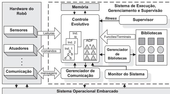
Figura 4.4: Estrutura modular do SEGS.
