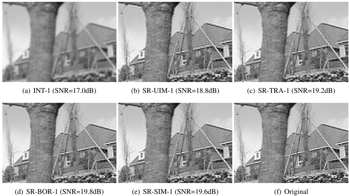
Figura 4.16: Exemplo visual mostrando a imagem 6 da seqüência Jardim, usando norma \ell_2 ao quadrado, modelos de primeira ordem e com detecção de outliers ativada .
