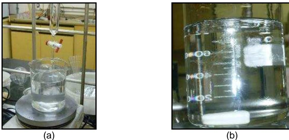
Figura 27 - Preparação da solução ácida para os ensaios de corrosão: (a) gotejamento lento; (b) filme polimérico, que foi disperso com a agitação
