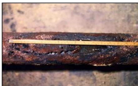
Figura 2 - Tubulação atacada uniformemente pela corrosão (ABRACO, 2010)
