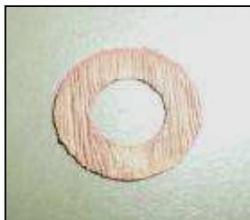
Figura 39 – Corpo de prova de latão submetido a ensaio de corrosão
