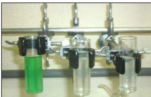
Figura 38 - Coloração da solução de ensaio de corrosão após ensaio de corrosão a 60°C com latão
