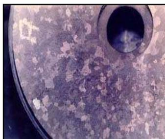
Figura 7 - Corrosão seletiva do zinco (ABRACO, 2010)
