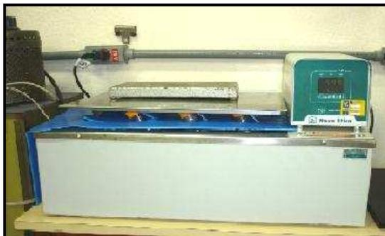
Figura 28 - Banho-maria usado no controle da temperatura na realização dos ensaios de corrosão
