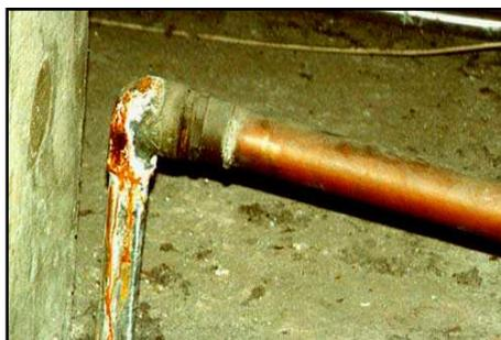
Figura 3 - Corrosão galvânica causada pelo contato do cobre com aço (Instituto Brasileiro de Desenvolvimento da Arquitetura, 2010)
