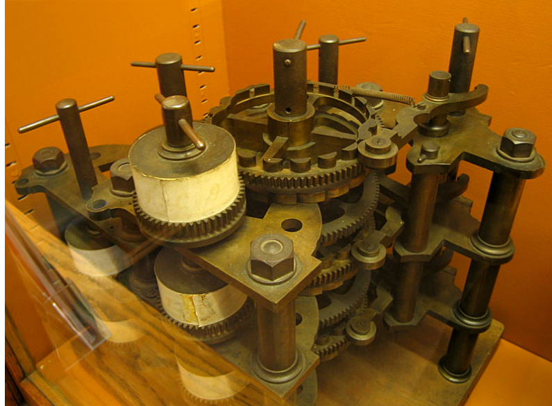
Fig. 3: Imagem parcial da calculadora de Babbage Fonte: http://pt.wikipedia.org/wiki/Ficheiro: BabbageDifferenceEngine.jpg
