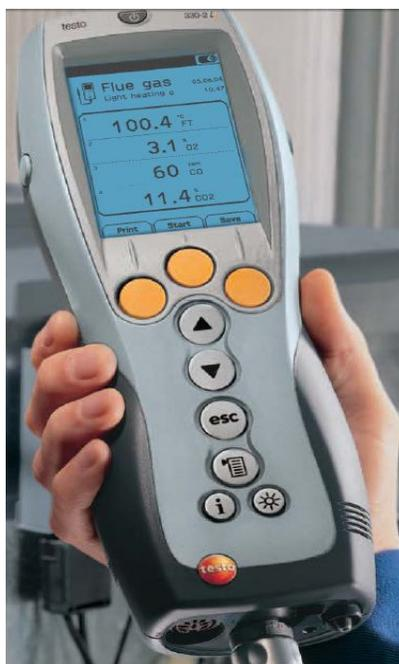
**Figura 4.4:** Analisador de gás TESTO 330-2 LL (manual Testo).
