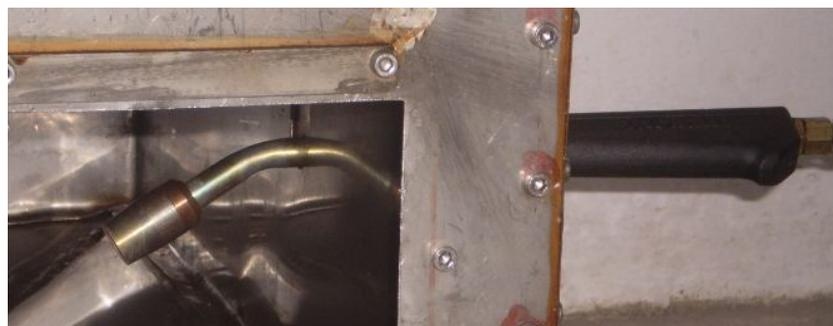
Figura 4.2: Queimador atmosférico.
