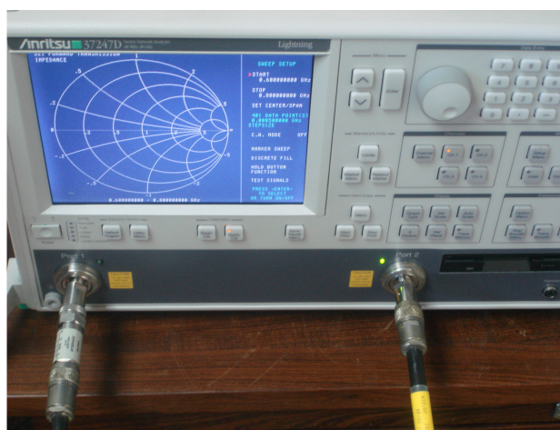
FIG. 5.5 Visualização do analisador de redes, do atenuador e dos cabos utilizados nas medidas.
