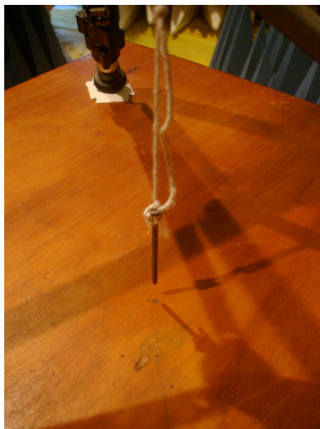
FIG. 5.6 Uso do prumo para o alinhamento do conjunto com a mesa fixa.
