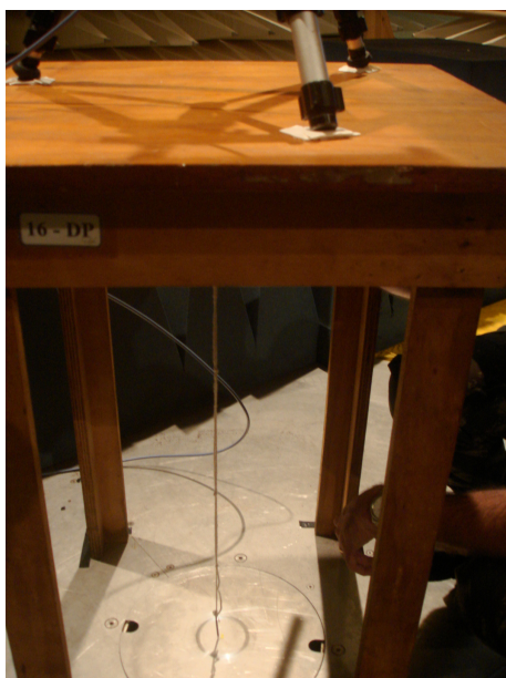
FIG. 5.7 Uso do prumo para o alinhamento da mesa fixa com a mesa giratória.
