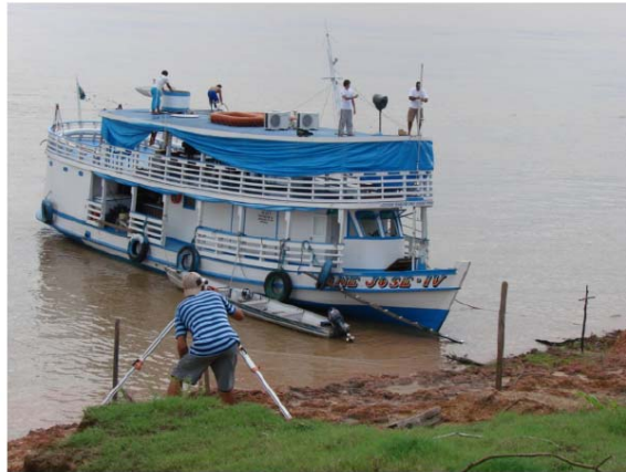
Figura 4.7 - Nivelamento de antenas GPS sobre o barco (Fonte:MOREIRA, 2010).
