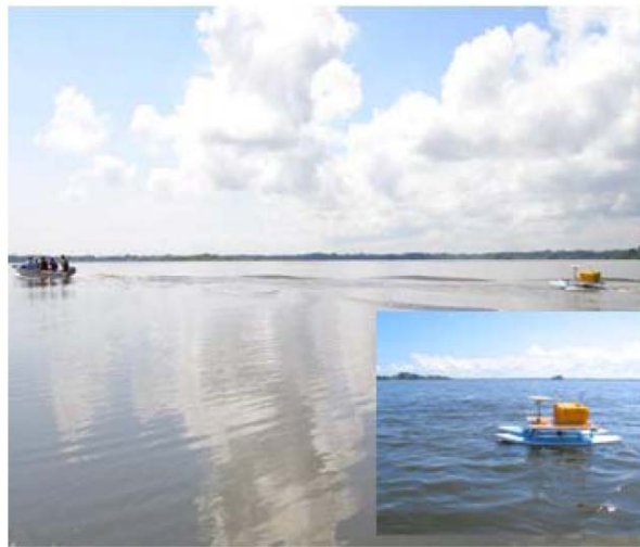
Figura 4.8- Medições de linha de água a partir do GPS flutuante (Fonte:MOREIRA, 2010).
