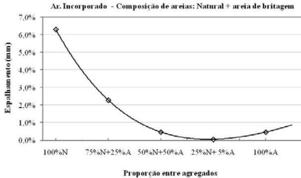
Figura A6 - Teor de ar incorporado para diferentes composições de areia natural e areia de britagem [LODI, 2006].
