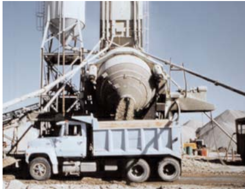
Figura 9 – Central de Concreto com misturador estacionário [KOSMAT- KA,2003].
