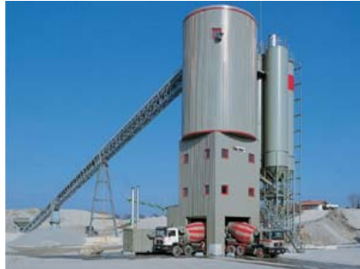
Figura 6 – Central Vertical ou de gravidade [STETTER, 2009]
