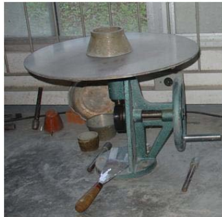
Figura A2 - Mesa para índice de consistência – Flow Table Test
