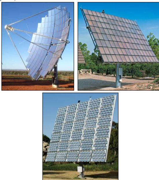
Figura 2.22 – Exemplos de SFVC produzidos com três diferentes tecnologias de concentrador.
