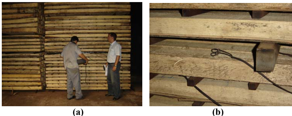
Figura 13 – Secagem da madeira: (a) determinação do teor de umidade com higrômetro resistivo portátil e (b) higrômetro resistivo do sistema controlador da estufa.
