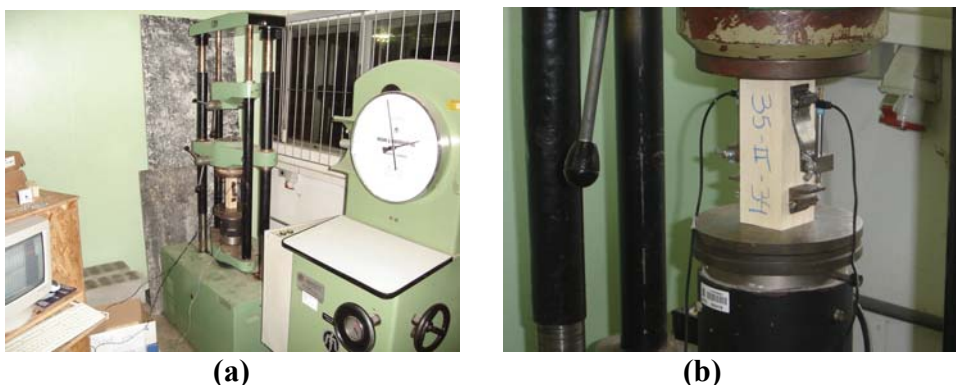
Figura 39 - Máquina Universal de Ensaios Mohr & Federhaff®: (a) ensaio de compressão paralela; e (b) em detalhe, transdutores de deslocamento acoplados e célula da carga embaixo do corpo de prova.
