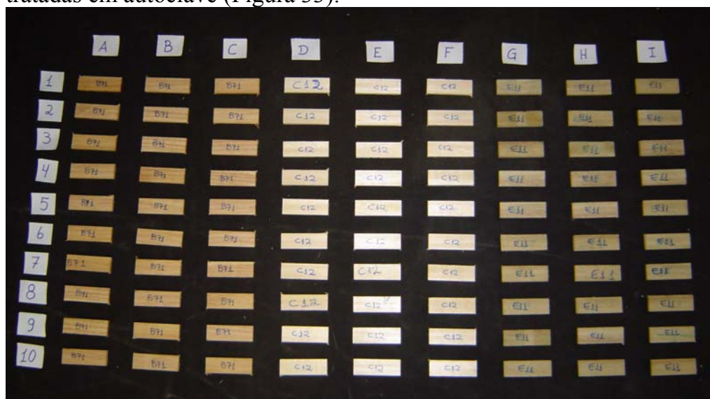
Figura 33 – Amostras para a determinação da resistência ao ataque de cupins de madeira seca.
