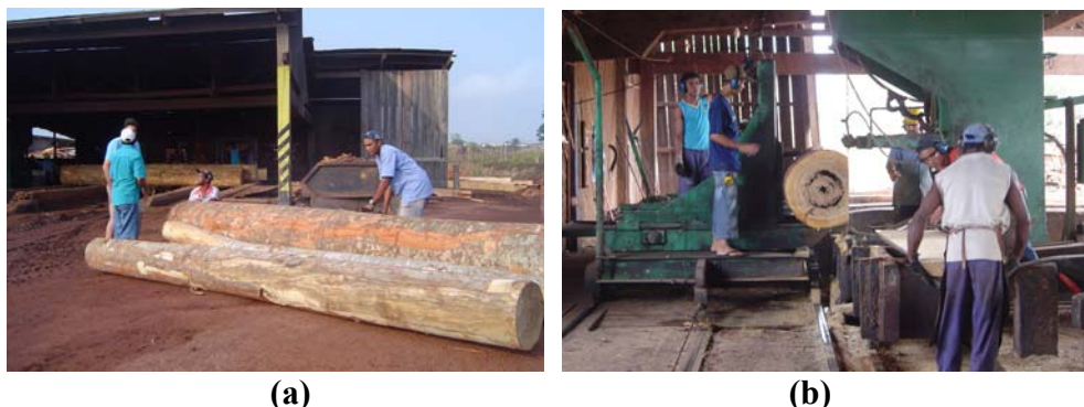
Figura 19 – Processamento da madeira: (a) corte da tora em toretes e; (b) torete sendo serrado em pranchas.
