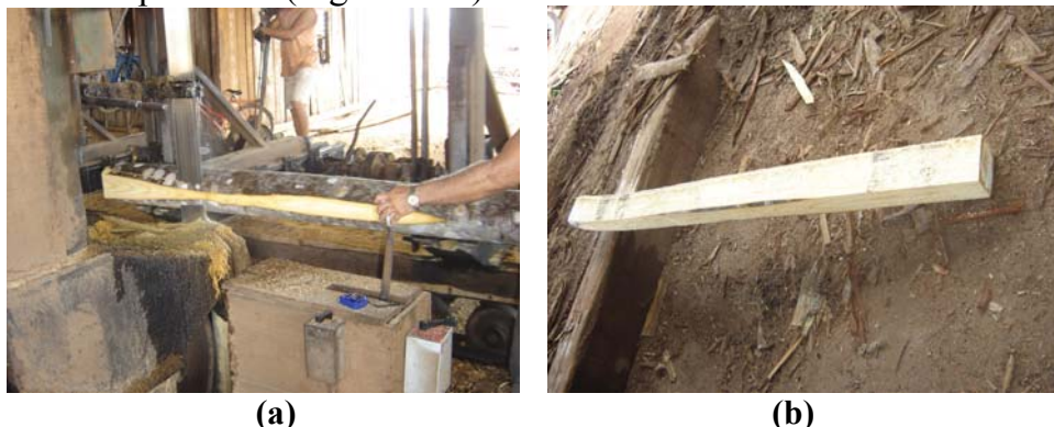
Figura 10 - (a) serragem dos toretes em serra fita com carro e (b) torete esquadrejado.
