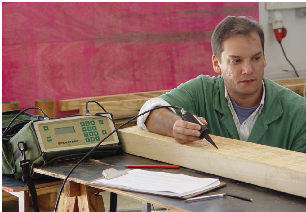
Figura 26 – Leitura da propagação de onda ultrassônica com equipamento Sylvatest®.
