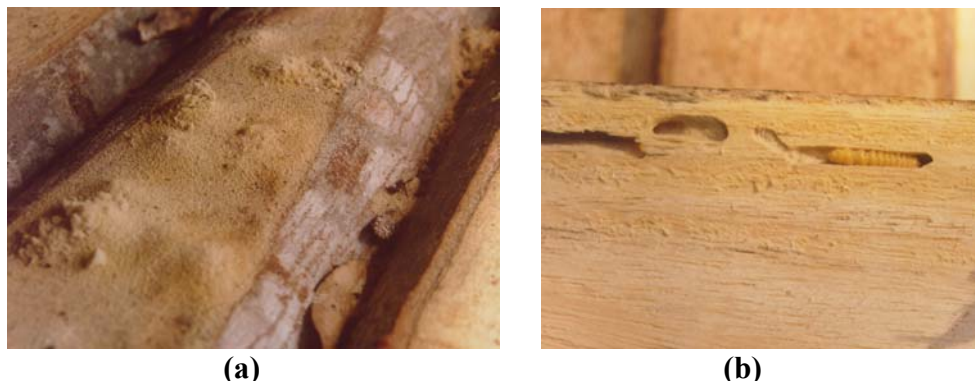
Figura 49 - (a) Ataque de brocas próximo à casca e (b) broca em ação.
