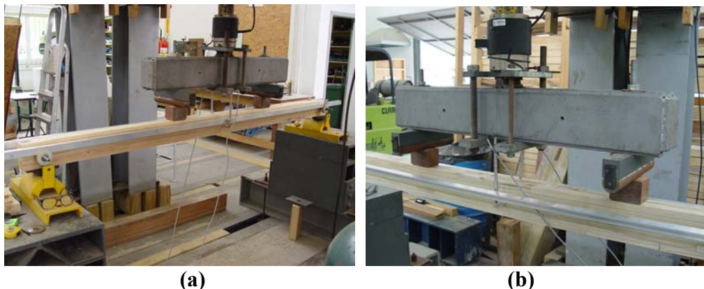
Figura 44 – Teste de flexão das vigas MLC: (a) esquema de ensaio a quatro pontos; (b) e posicionamento dos transdutores de deslocamento entre os pontos de aplicação de carga.
