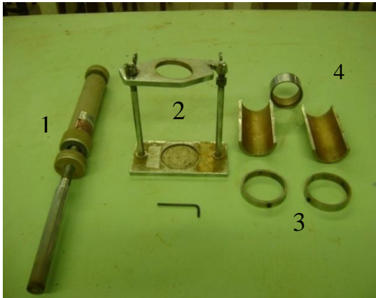
Figura 21(a) – Ferramentas utilizadas na moldagem de corpos de prova compactados: 1. Tambor cilíndrico oco; 2. Base de aço inoxidável; 3. Anéis utilizados para confinar o cilindro; 4. Cilindro bipartido.
