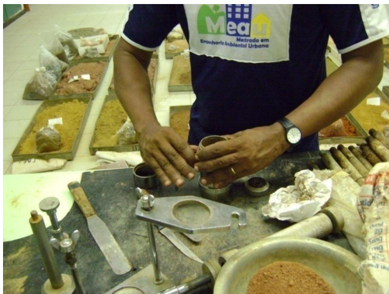
Figura 17 - Montagem do equipamento utilizado na moldagem do CP por pisoteamento.
