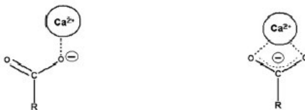
Figura 25: Esquema ilustrativo de diferentes tipos de ligação entre \text{Ca}^{2+} e grupo \text{-COO}^- : \text{-COO}^- monodentado (esquerda) e ligação bidentado (direita) (PLANK E SACHSENHAUSER, 2009).
