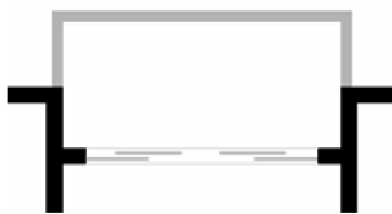
Figura 16 - Sacada parcialmente em balanço
