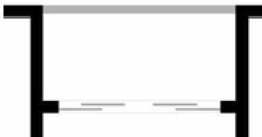
Figura 15 - Sacada interna à projeção do edifício.
