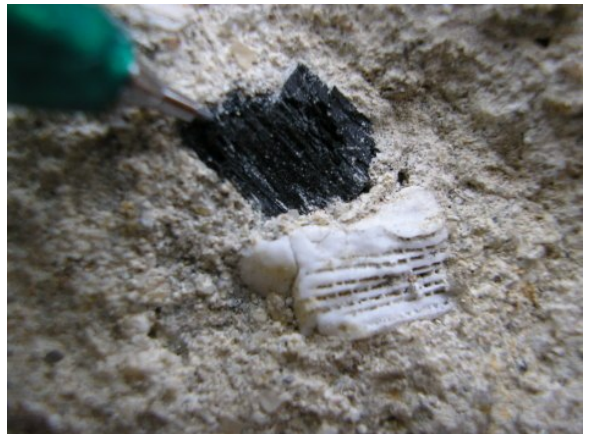
Figura 92: Presença de fragmento de agregado biogênico e de carvão, indicando uma calcinação incompleta (N29)
