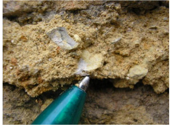
Figura 90: Fragmento de agregado biogênico, frequente nestas argamassas, indicam uma calcinação incompleta da cal (N13)
