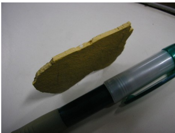
Figura 95: Argamassa pigmentada espessa (WW14 - porta principal)
