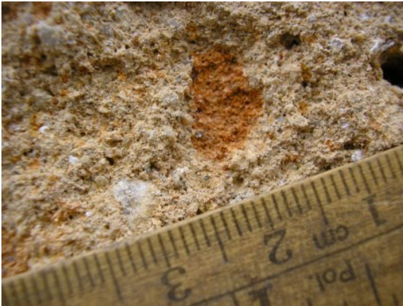
Figura 89: Torrão de argila presente no emboço alaranjado, frequentemente maior que 5mm (N13)
