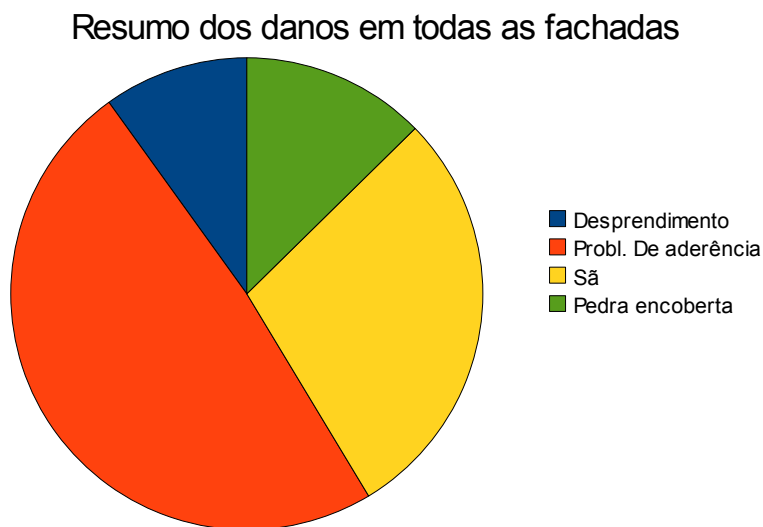
Figura 60: Resumo comparativo dos danos encontrados em todas as fachadas inspecionadas
