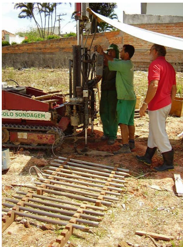
FIGURA 12 - Foto da preparação do ensaio DMT
