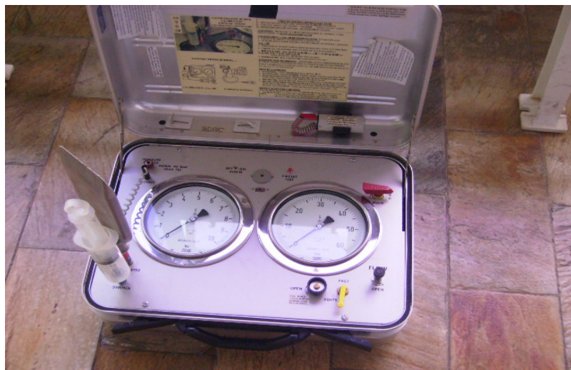
FIGURA 13 - Foto da calibração da membrana com seringa (acessório)
