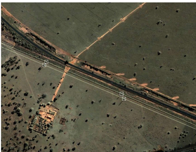
Figura 25 - Representação gráfica planimétrica do eixo diretriz de uma LT.
