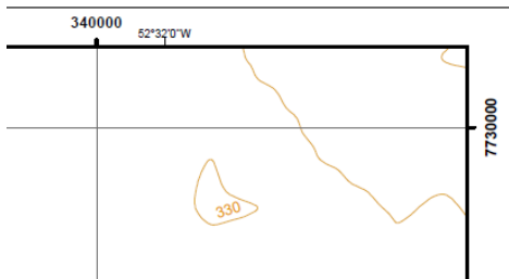
Figura 73 - Grade de coordenadas geodésicas.
