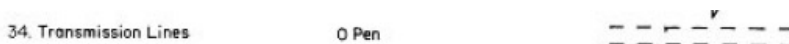
Figura 35 - Símbolo para representação de LT segundo Standard on Manual Cadastral Maps and Parcel Identifiers .
