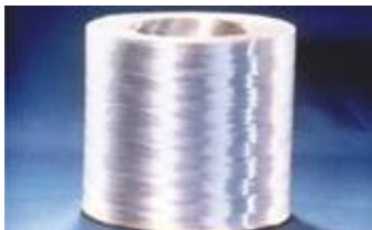
Figura 2.1 – Filamento contínuo ( rovings )
