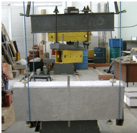
Figura 3.22 – Instabilidade global do V3
