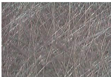
Figura 2.3 – Manta de fibras picotadas ( chopped-strand mat )
