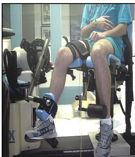
Figura 15. Teste utilizando a EENM para produção involuntária de 55% do torque isométrico máximo voluntário (TIMV), a partir da posição de 60° de flexão do joelho direito.
