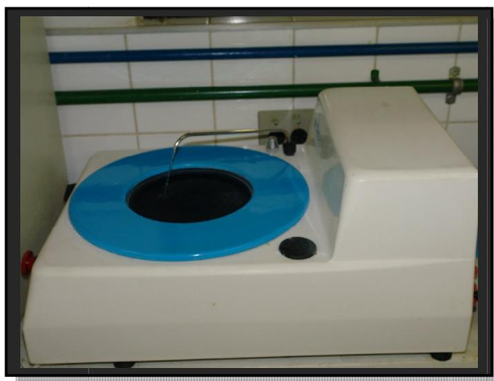
**Figura 19:** Politriz (Arotec modelo AROPOL 2V 0610433) utilizada para polimento dos eletrodos com alumina.
