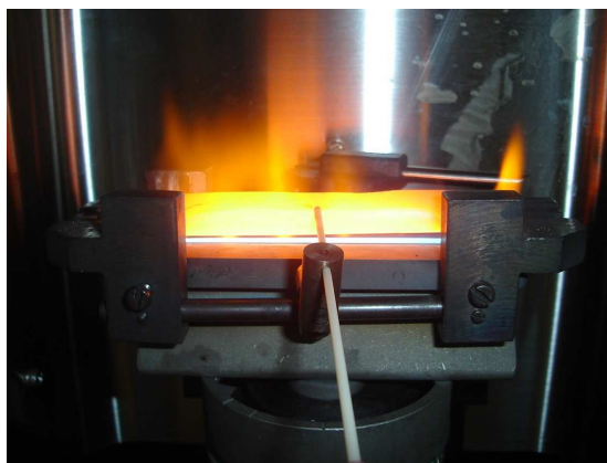
Figura 6- Fotografia do tubo de Ni sobre a chama e o capilar cerâmico para o sistema em funcionamento.
