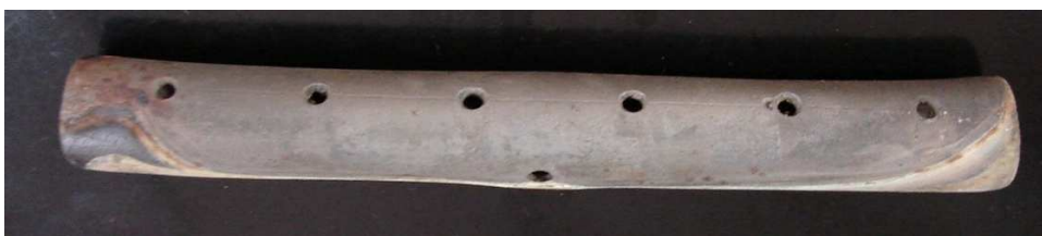
Figura 4 – Configuração do tubo utilizado no sistema TS-FF-AAS.
