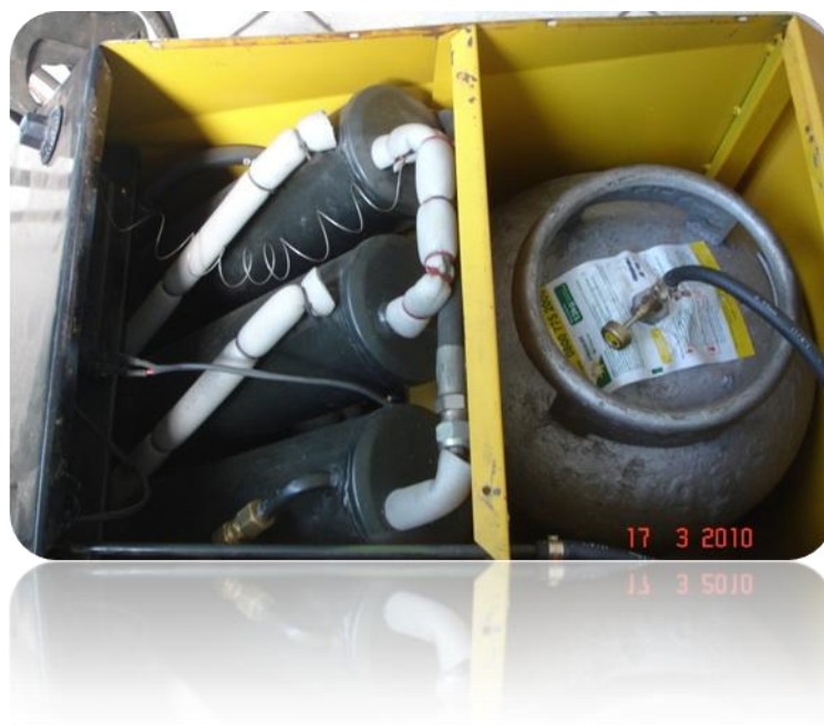
Figura – 6 Vista Superior Câmaras de Queima e Unidade Combustível P13 - Fonte George Bauer.
