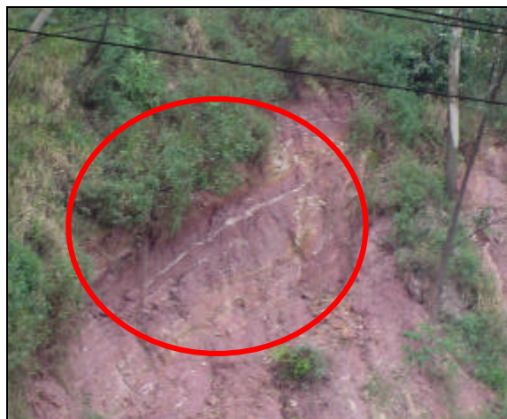
Foto 07 – Notar a xistosidade e o bandamento no micaxisto. O círculo vermelho indica um veio de quartzo migmatizado.
