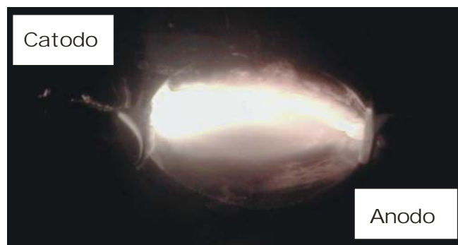
Figura 1.3 – Lâmpada D2S-35W alimentada em corrente contínua.
