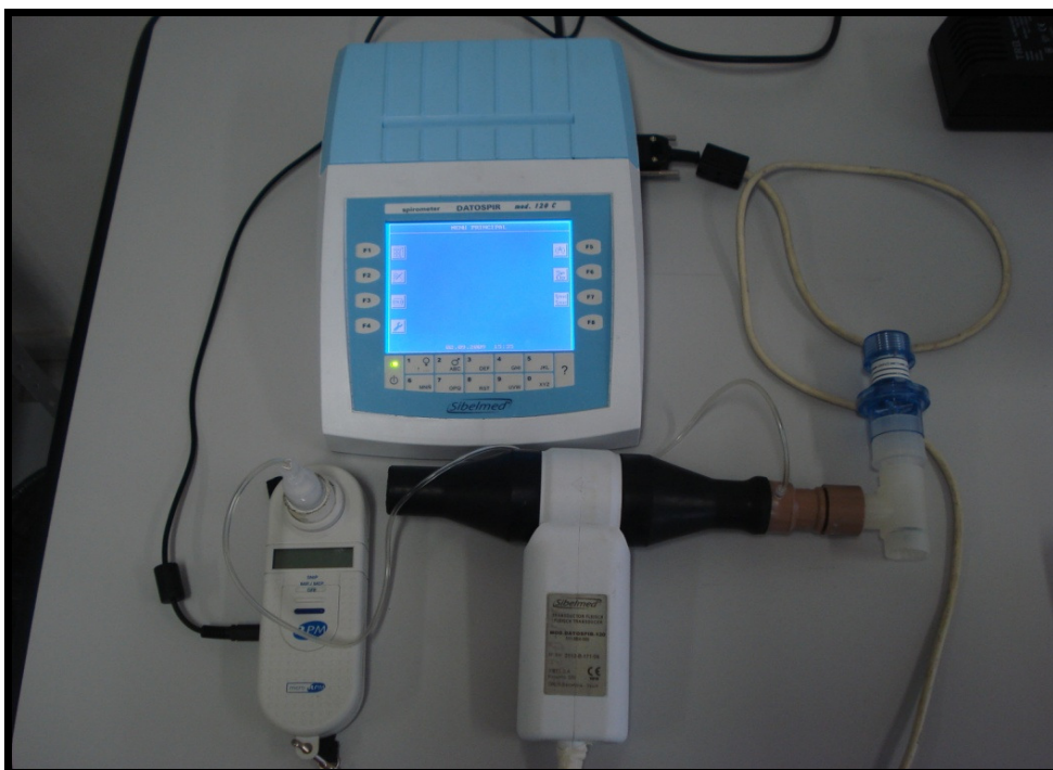
Fig.3: Modelo do espirômetro com circuito fechado ligado a um transducer de pressão
