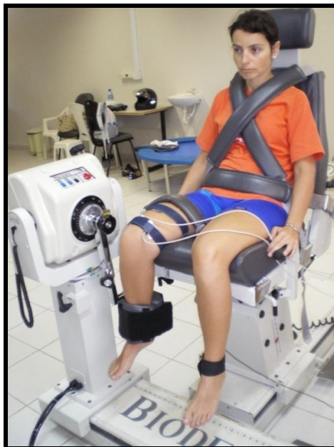
Figura 04: Posicionamento da voluntária na cadeira do dinamômetro isocinético.
