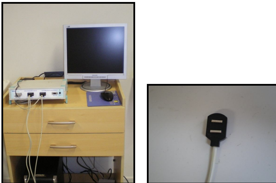
Figura 01: Eletromiógrafo de 8 canais e eletrodo ativo diferencial simples de superfície utilizados no experimento (EMG System do Brasil Ltda.).
