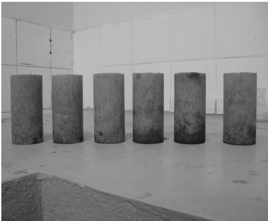
Figura 14: Corpos-de-prova da argamassa com o polímero (SAC 1,00) após serem retirados da forma.
