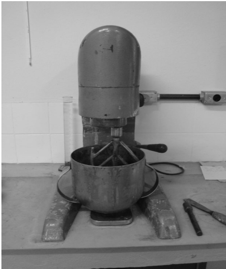
Figura 12: Misturador mecânico usado no preparo das argamassas.
