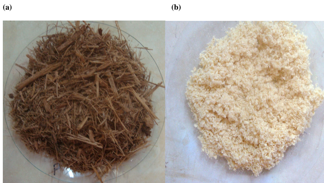
Figura 22: Aspecto físico do bagaço de cana-de-açúcar: (a) bruto e (b) purificado.
