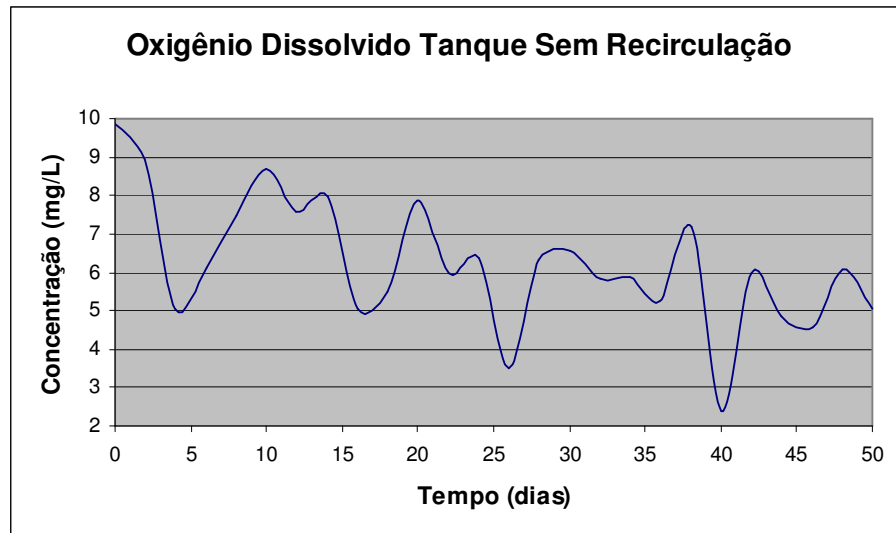
Figura 5.23: Variação ao longo do tempo do Oxigênio Dissolvido no tanque de cultivo do sistema sem recirculação.
