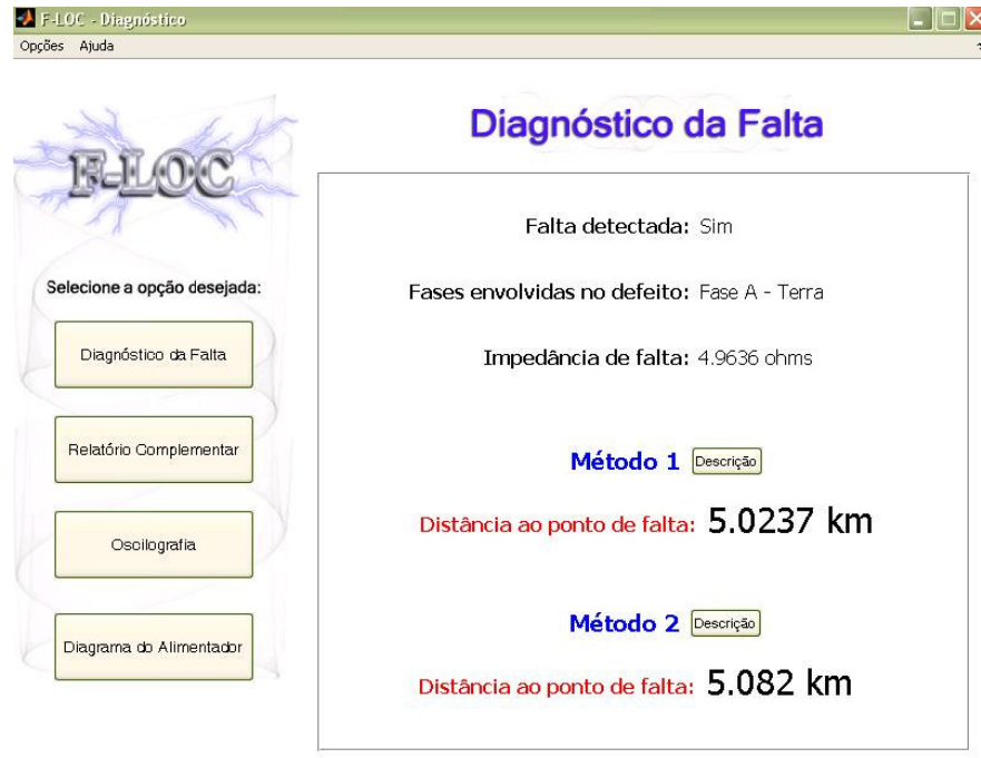
Figura 7.8 – Tela de Diagnóstico de Falta de Baixa-Impedância.
