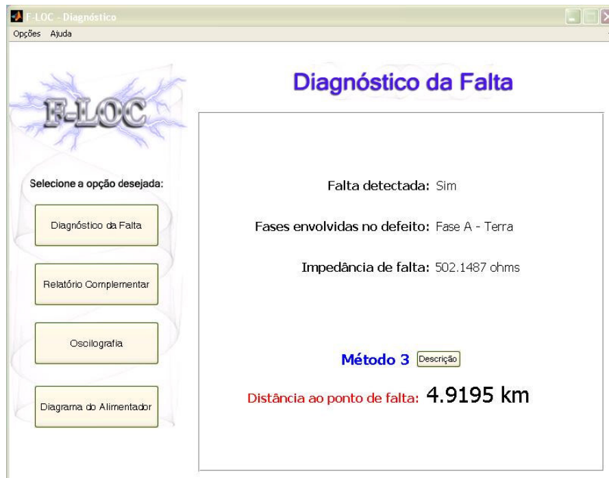
Figura 7.10 – Tela de Diagnóstico de Falta de Alta-Impedância.
