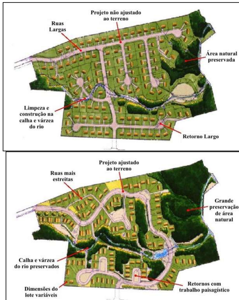
Figura 2.3. Diferença de planejamento da drenagem entre a técnica convencional e LID (Souza, 2005).
