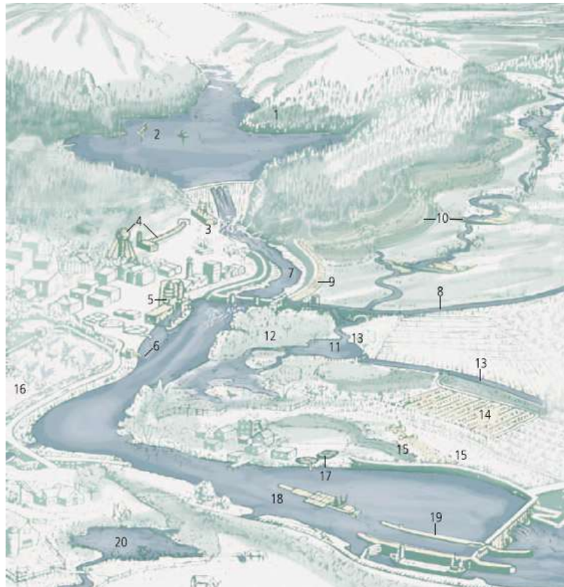
Figura 2.5. Principais funções e serviços ambientais de uma típica bacia hidrográfica (Smith et al. , 2006). Legenda: 1. Floresta, controle de sedimentação; 2. Recreação e armazenamento de água; 3. Hidrelétrica; 4. Abastecimento de água; 5 e 17. Estações de tratamento de efluentes municipais e industriais; 6. Bombeamento para reservatórios de irrigação; 7. Lago ou reservatório para recreação; 8 e 13. Canal de irrigação; 9. Dique para controle de inundação; 10. Controle de erosão; 11. Bacia de regulação para irrigação; 12. Refúgio para fauna silvestre; 14. Irrigação por gravidade; 15. Contorno de lavouras (proteção); 16. Irrigação por aspersão; 18. Estrutura de navegação; 19. Re-regulação de reservatório com comportas; 20. Reservatório para piscicultura.
