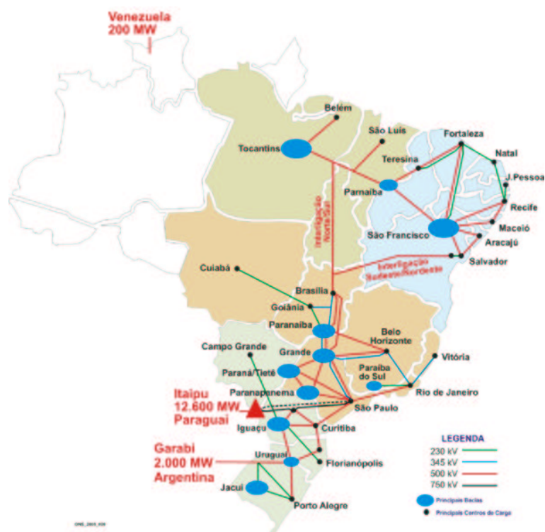
Figura 1.7: Sistema Interligado Nacional (SIN), caracterizado por ser um sistema hidrotérmico de grande porte, com forte predominância de usinas hidrelétricas e com múltiplos proprietários (fonte: www.ons.gov.br ).
