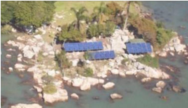
**Figura 15. Sistema fotovoltaico isolado instalado na Ilha de Ratonés.**
