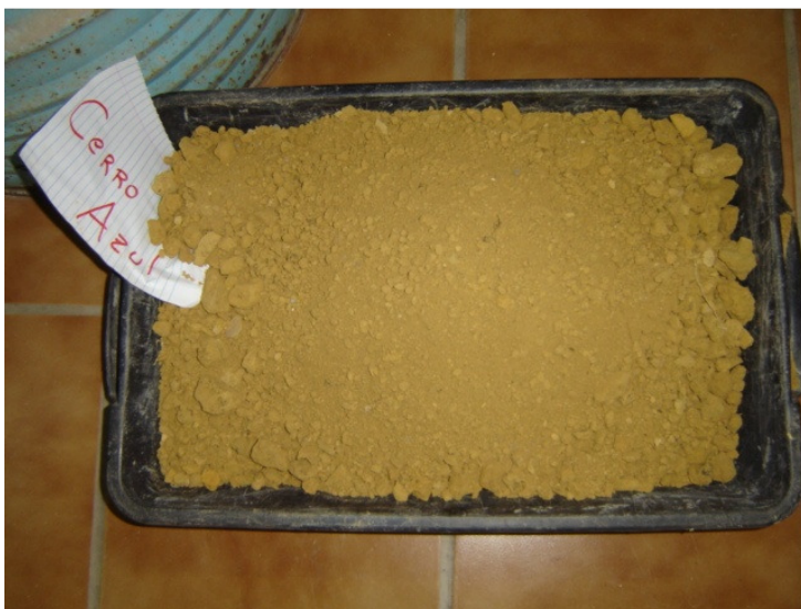
Figura 17 - Secagem do solo em laboratório
