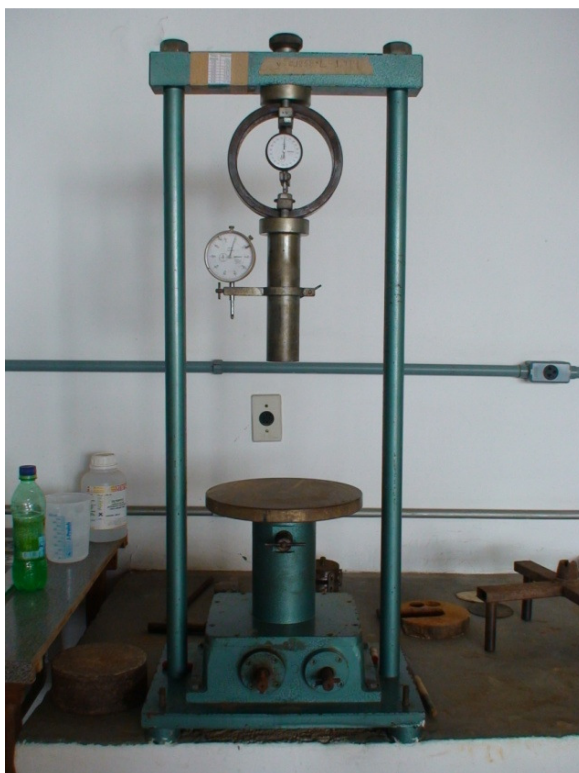
Figura 19 - Prensa utilizada no ensaio do ISC
