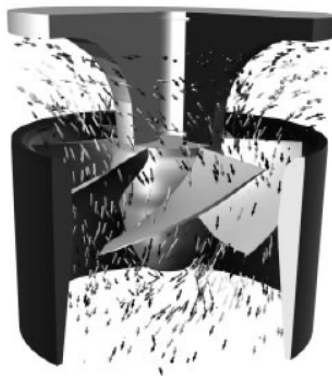
Figura 2.26 – Simulação de um modelo de turbina Kaplan. Este estudo de caso descreve a utilização da visualização do resultado de simulação CFD para o projeto de turbinas (fonte: (Roth e Peikert, 1996).
