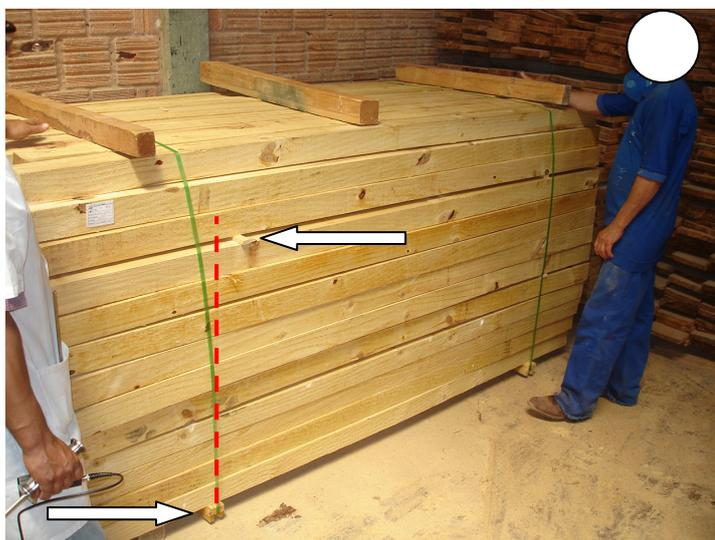
Figura 9 – Separadores de madeira maciça desalinhados
