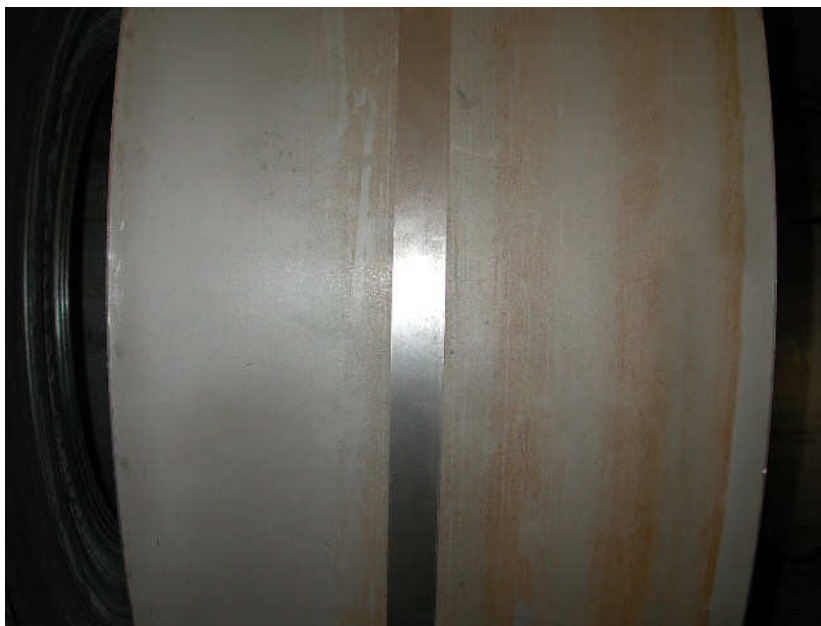
Figura 10. Mancha em aço-carbono, proveniente de contaminação da água de lavagem por cloreto.
