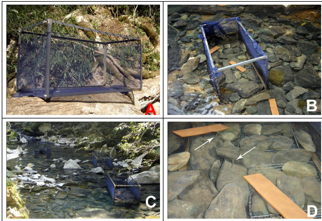
Figura 5. - Desenho experimental usado no experimento para avaliar o efeito de diferentes grupos funcionais de peixes sobre as comunidades de macroinvertebrados e o perifíton do córrego Salobrinha (Bodoquena, MS). (A) Gaiola pronta, de armação de ferro, já com a malha de 5 mm. (B) note a abertura de um dos lados da gaiola à esquerda, usada como controle (para mais detalhes, veja o texto). (C) Gaiolas dispostas em blocos dentro do riacho. (D) detalhe do interior de uma gaiola, com a bandeja contendo os blocos; note a presença de Astyanax lineatus confinado na gaiola (setas).
