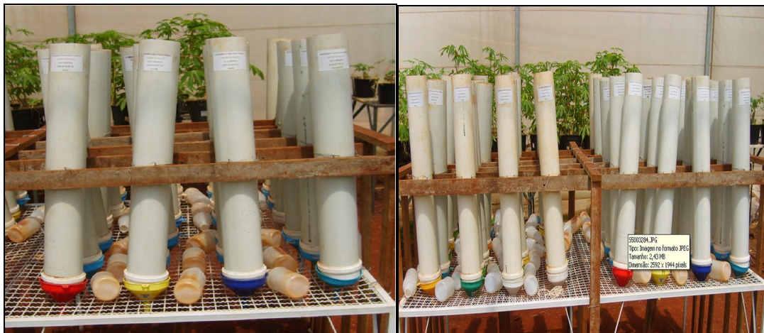
Figura 2. Colunas de percolação com o perfil de solo reconstruído e instalado na casa de vegetação. UNIOESTE. Marechal Cândido Rondon, 2010.
