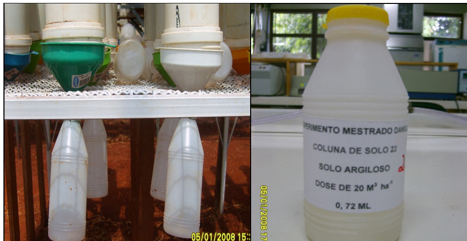
Figura 3. Implementação dos tratamentos no experimento com colunas de percolação e detalhe dos frascos utilizados para a coleta da solução percolada e para armazenagem em freezer. UNIOESTE. Marechal Cândido Rondon, 2010.
