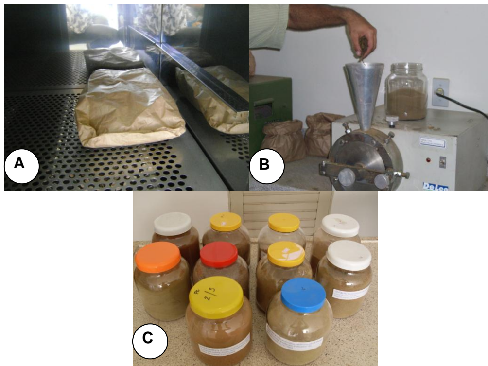
Figura 5 – A. Estruturas vegetais em sacos de papel tipo kraft sendo secas em estufa; B. Estruturas vegetais sendo trituradas em moinho; C. Pós armazenados individualmente em recipientes de vidro hermeticamente fechados.
