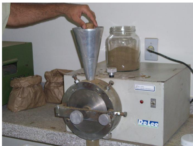
FIGURA 5 – Material vegetal triturado em moinho de facas.
