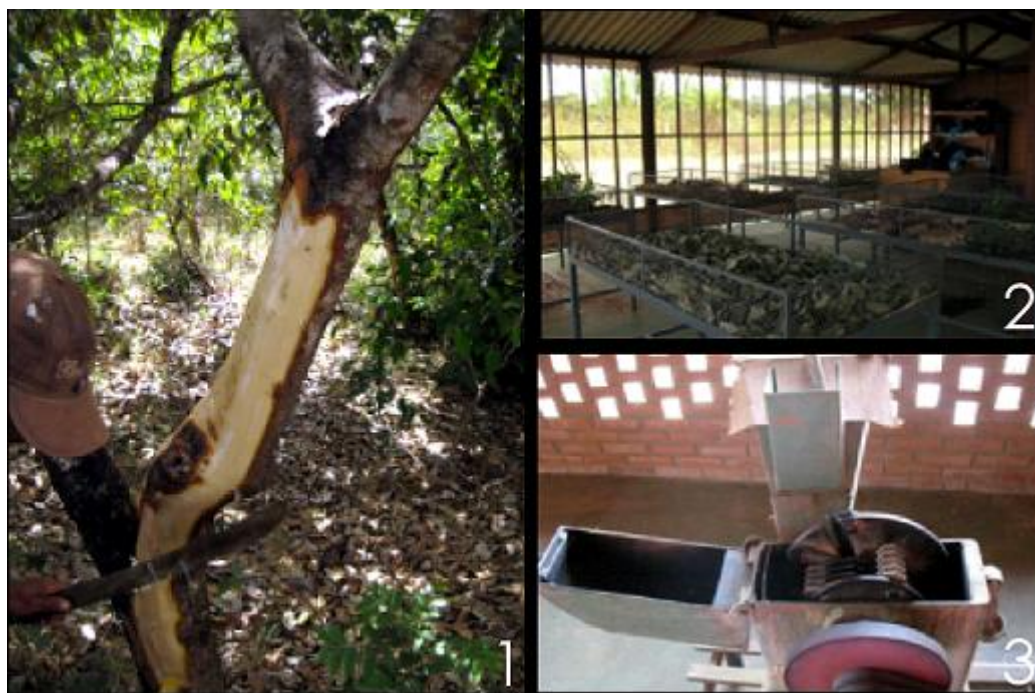
Figura 69: 1- Coleta de casca do caule; 2- Secagem do material vegetal; 3- Moinho de facas utilizado para pulverizar o material vegetal.
