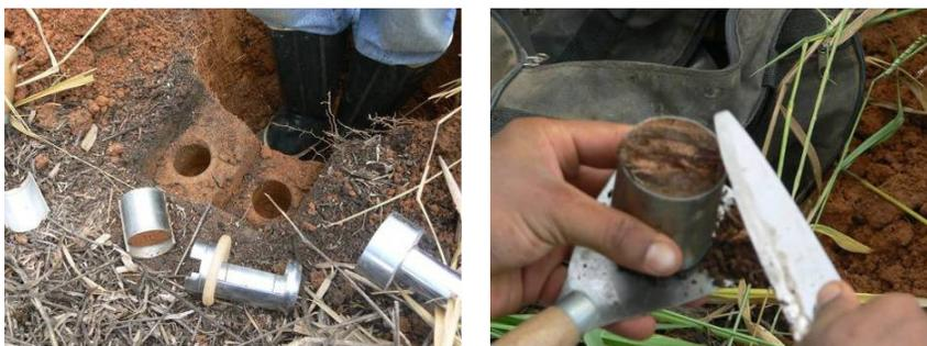
Figura 6.2 – Amostragem de solo para obtenção da densidade
