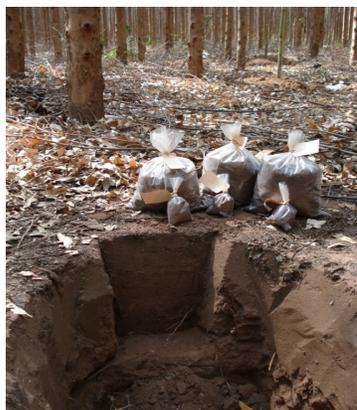
Figura 3.5 - Vista geral da mini-trincheira, instalada em uma das áreas de eucalipto, após a coleta das amostras
