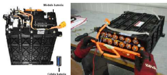
Figura 2.38 - Desmontagem do módulo e células da bateria de alta tensão do Honda Civic Híbrido para facilitar a entrada nos processos de reciclagem
