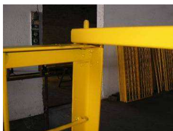
(a) encaixes com hastes móveis para facilitar a montagem/desmontagem
