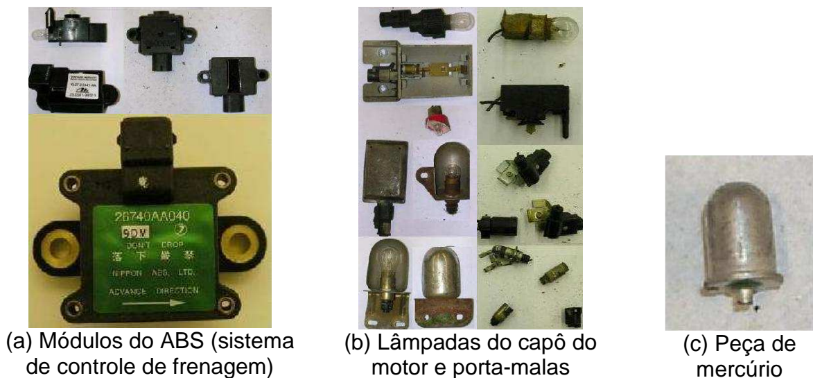
Figura 2.39 - Exemplos de componentes automotivos que contém mercúrio (NVMSRP, 2009)
