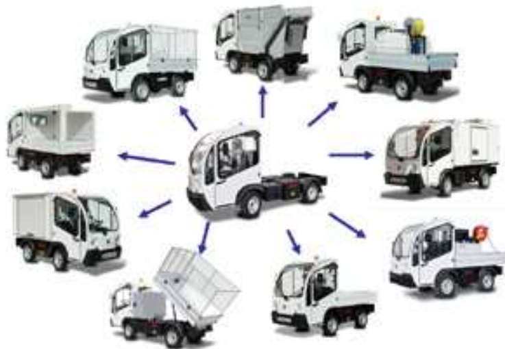
Figura 2.75 - VEB tripulados para transporte de cargas: modularidade de containeres e funções apoiados sobre o chassi (GOUPIL, 2010)
