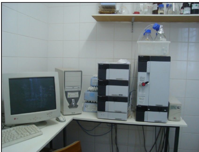
Figura 17. Cromatógrafo líquido de alta eficiência utilizado para as análises das amostras coletadas no ambiente do estudo.
