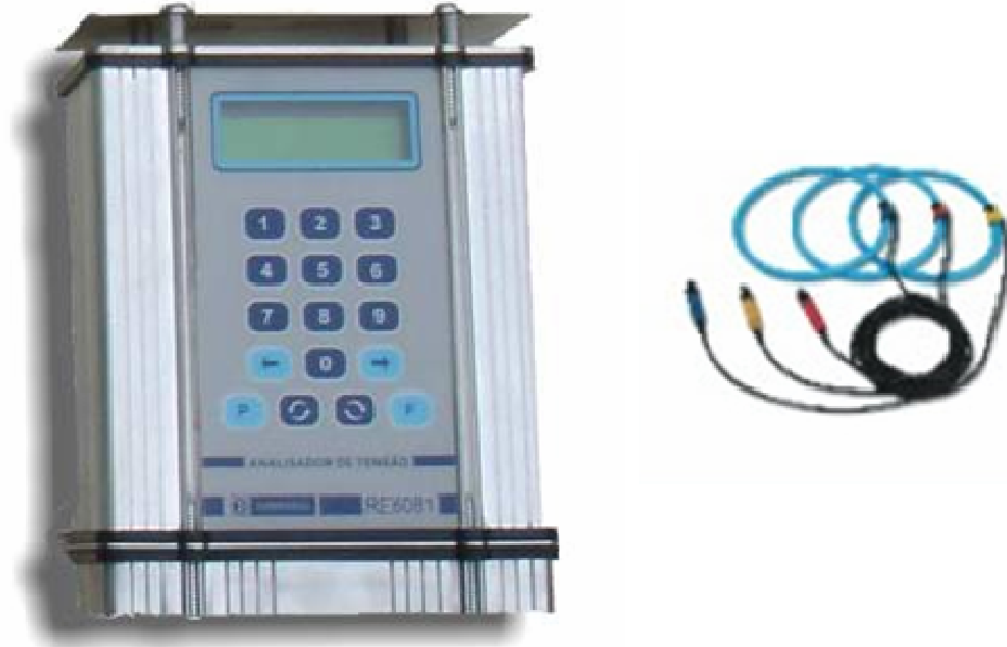
Figura 60 – Analisador RE 6081 e os sensores de corrente
