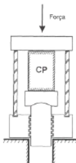
Figura 5.2 – Ruptura do Concreto à Compressão
