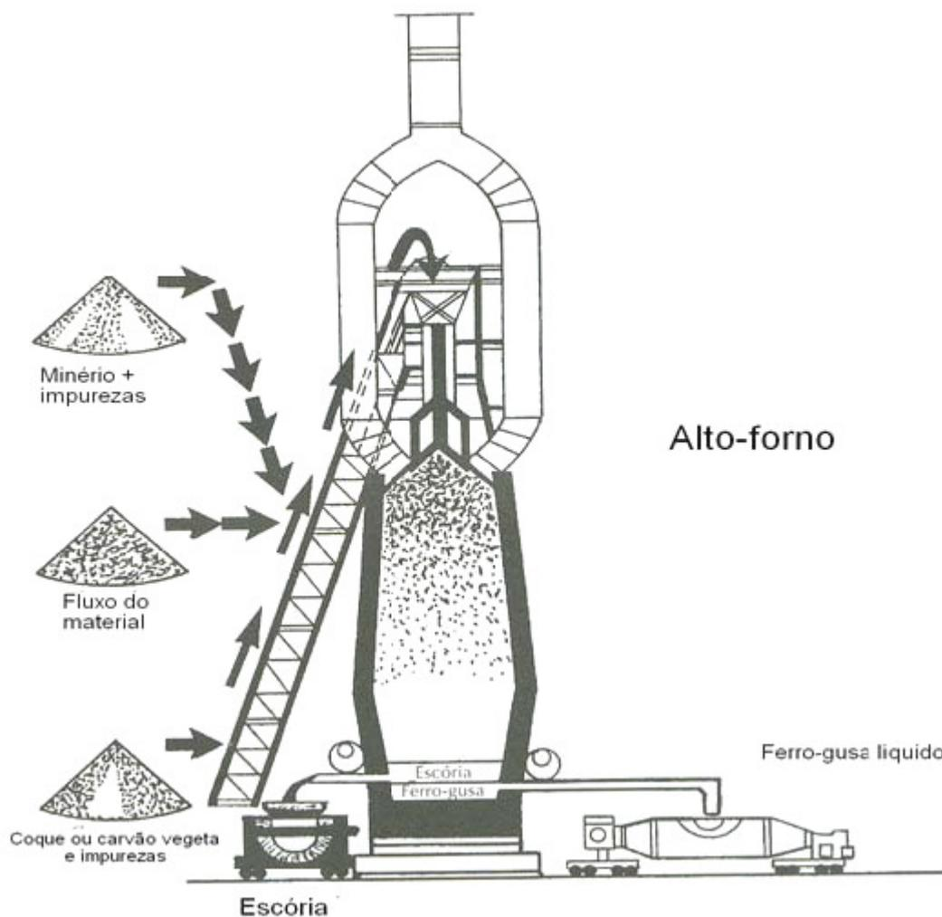
Figura 4.5 – Representação esquemática de um alto-forno – adaptado de JACOMINO, 2002 et al. apud MASSUCATO, 2005.
