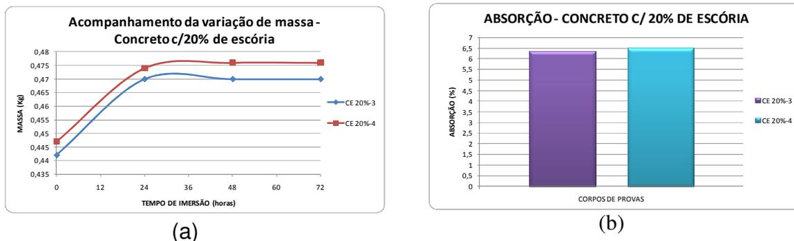
Figura 6.9 – Resultados do ensaio de absorção por imersão no concreto com adição de 20% de escória de alto-forno após do ataque com ácido
