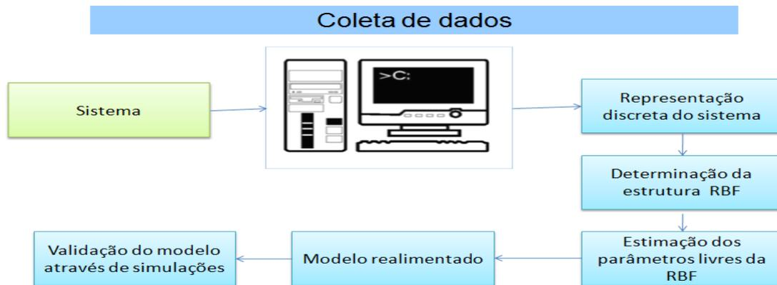
Figura 21 – Diagrama representando todos os passos do presente trabalho, desde a aquisição e coleta de dados até a validação e apresentação dos resultados obtidos.
